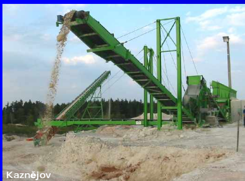
třídící linka SMP (viz. vpravo) po 6 měsících provozu
