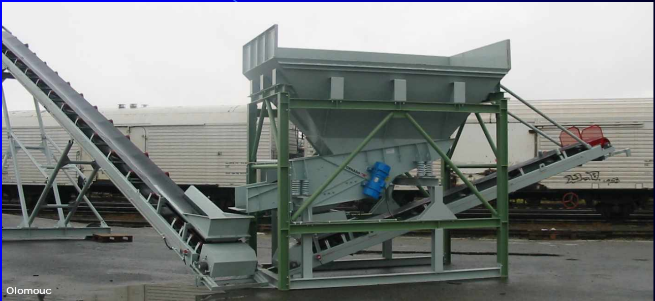
semimobilní třídírna SMP 080.2 s prstovým tříděčem TORNÁDO MP
