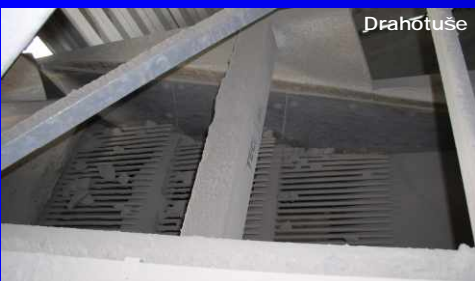
detail prstového tříděče TORNÁDO MP z SMP 080.3
