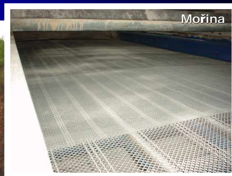
úprava třídiče RT 2 x 6,7 na boční napínání
