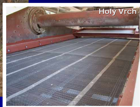
úprava třídiče SDT 1,8 x 4 na boční napínání
